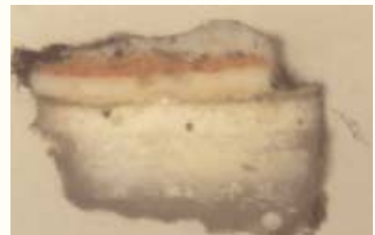
200fache Vergrößerung einer Fassungssprobe (Querschliff)
